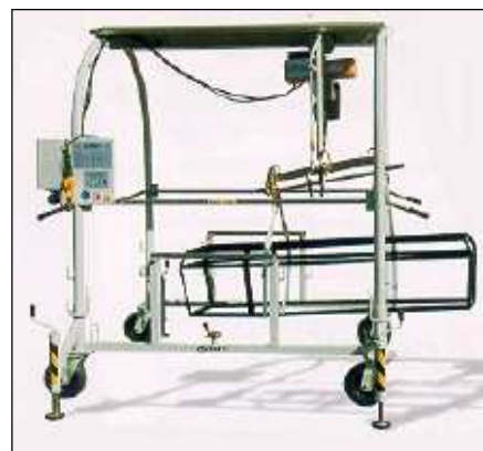
Lo scorrimento longitudinale del paranco permette di ottenere ottimi risultati laddove si debba tumulare in condizioni di non facile accessibilità.
