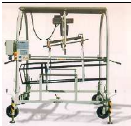
Lo scorrimento longitudinale del paranco permette di ottenere ottimi risultati laddove si debba tumulare in condizioni di non facile accessibilità.
