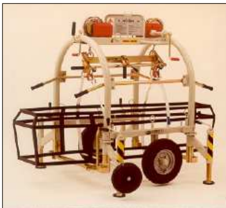
Calabare in posizione di lavoro, con gli stabilizzatori aperti in una delle tre possibili posizioni, indicate nel disegno sottostante (vista dall'alto del calabare nelle possibili posizioni di lavoro).
