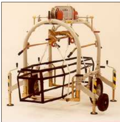
Calabare in posizione di lavoro, con gli stabilizzatori aperti in una delle tre possibili posizioni, indicate nel disegno sottostante (vista dall'alto del calabare nelle possibili posizioni di lavoro).
