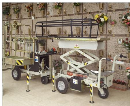
Il piano bara è dotato di rulli per favorire lo scorrimento della bara durante le operazioni di traslazione del feretro. Durante la movimentazione, i rulli vengono bloccati con un apposito dispositivo e la bara viene assicurata con le cinghie in dotazione.
