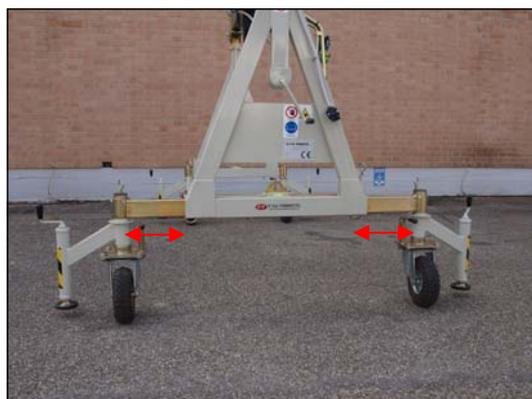
Aumenta ulteriormente la versatilità dell'alzastre/calabare, permettendo di allargarne la base d'appoggio e di traslazione in modo da adattarla alla conformazione della tomba, nonché di sfruttare la
