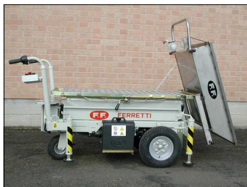
Il cassone ribaltabile permette di trasformare la lettiga in una pratica carriola elettrica utile per lo spostamento di piccole quantità di materiale (portata max 80 kg). È realizzato in acciaio inox. Installazione e rimozione sono estremamente semplici.
