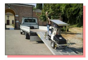
L'elevatore può essere agevolmente caricato e scaricato da un mezzo mediante apposite rampe.
