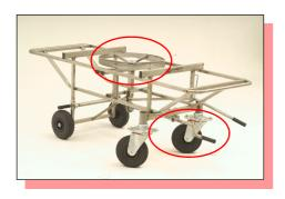
Azionato in modo semplice da una leva, permette di sollevare leggermente la bara e di ruotarla di 90°, per facilitare le operazioni di movimentazione e traslazione del feretro.
